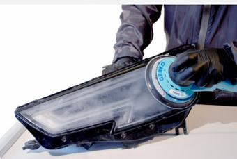
3. Den Scheinwerfer mit den verschiedenen gerko-Folienschleifpapieren schrittweise mit Wasser anschleifen, bis die vorherige gelbliche Lackschicht vollständig entfernt ist. Anschließend säubern, um sicherzustellen, dass der gesamte Scheinwerfer gleichmäßig geschliffen ist.
