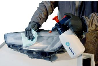
1. Nettoyer soigneusement le phare et le sécher avec un chiffon propre.
